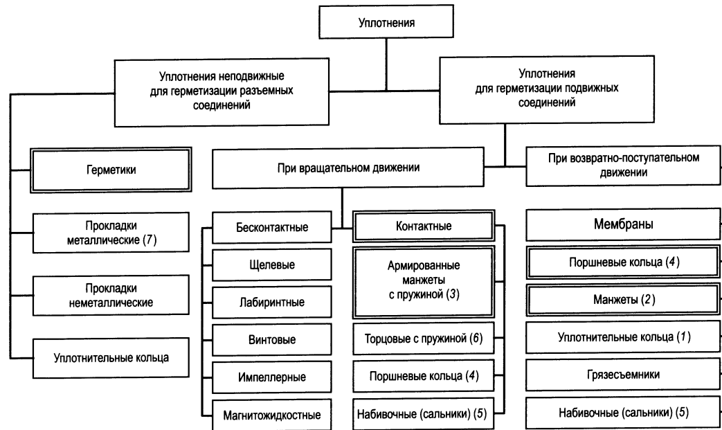
Рис 22.7.1. Типы уплотнений (в двойной рамке приведены уплотнения, имеющие преимущественное применение)
