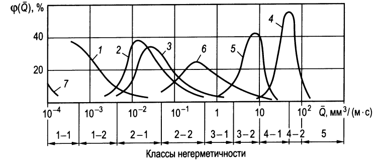
Рис 22.7.2. Функции распределения утечек для уплотнений с индексом 1-7 (см. рис. 22.7.1)
